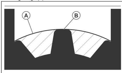
5. Si le niveau de graisse est trop bas, remplissez le renvoi d'angle avec de la graisse pour renvoi d'angle Husqvarna. Remplissez lentement et tournez l'arbre d'entraînement tout en appliquant la graisse pour renvoi d'angle, puis arrêtez-vous lorsque vous atteignez le niveau correct (B).
