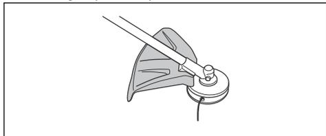
3. Remplacez la protection de l'équipement de coupe si celle-ci est endommagée.
