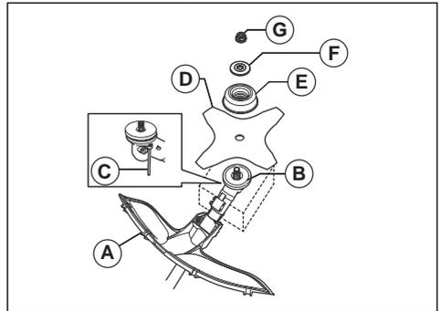
5. Assurez-vous que le disque d'entraînement et la bride de support s'engagent correctement dans le trou central de la lame à herbe.
