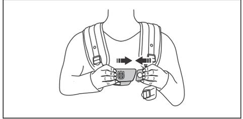
4. Si le harnais est équipé d'un coussinet de hanches et d'une sangle de hanches, assurez-vous que la fonction de desserrage rapide fonctionne correctement.
