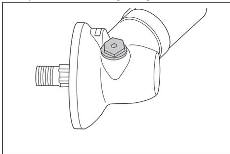
4. Regardez dans l'orifice du bouchon de graissage et tournez l'arbre d'entraînement. Le niveau de graisse (A) doit être au même niveau que le haut des dents d'engrenage (B).
